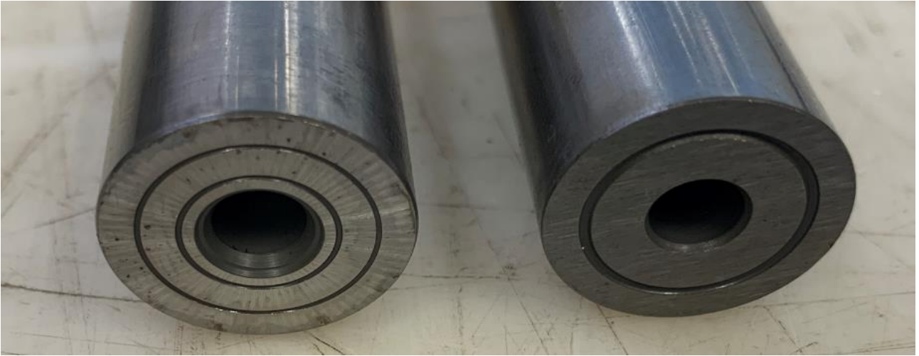
Kuva 14. Kohta B. Mäntien päiden koneistusmenetelmä on erilainen. (Kawasaki vas, tutkittava oik)
