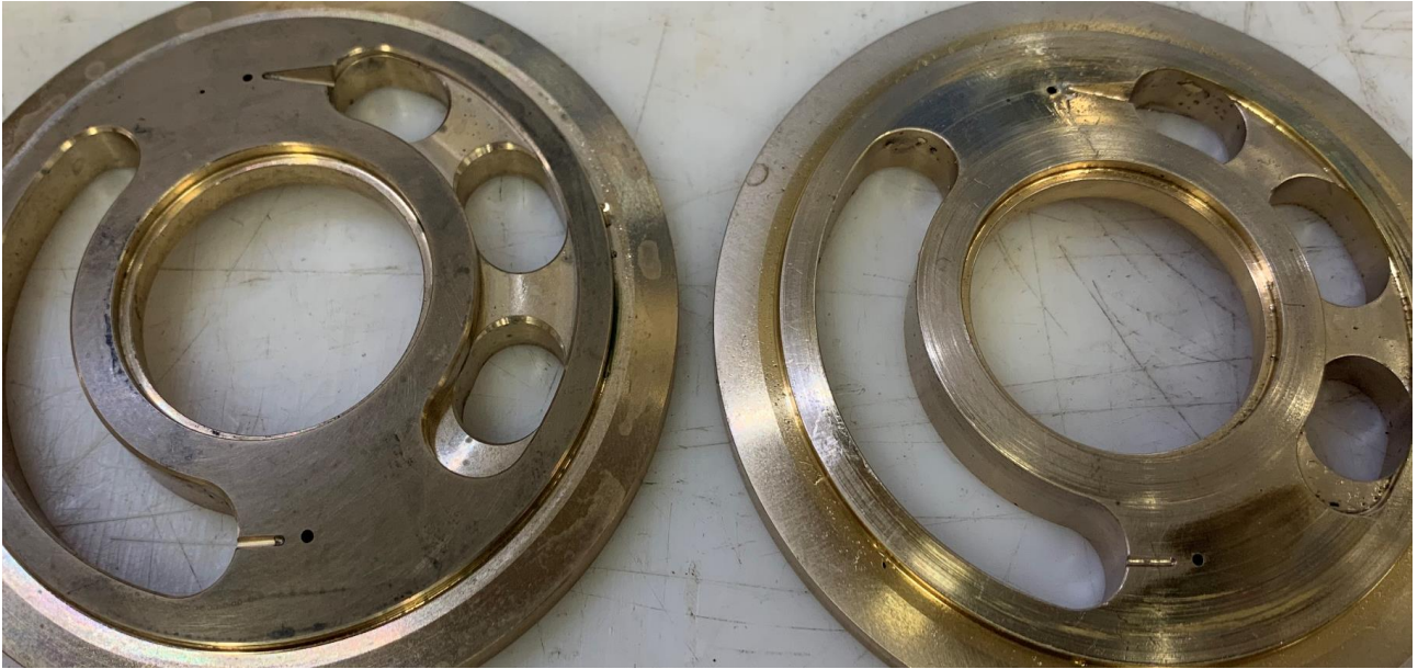
Kuva 17. Kohta B. venttiililevyjen viisteet eroavat. (Kawasaki vas, tutkittava oik)
