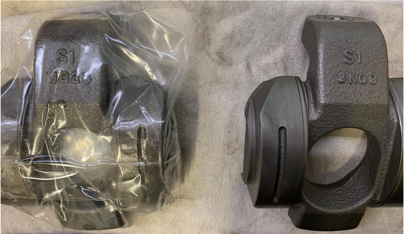
Kuva 25. Kohta B. Vinolevy vastaa Flutek-levyä. (Flutek vas, tutkittava oik)
