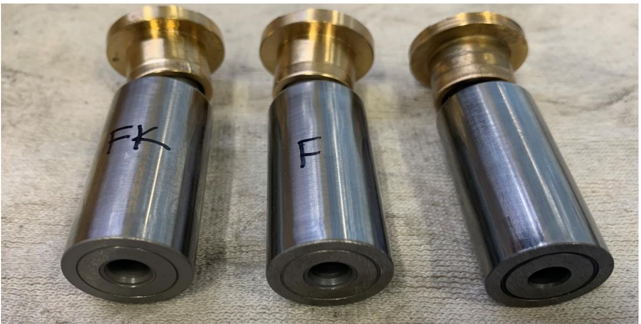
Kuva 20. Kohta B. Mäntien päiden koneistus on erillainen. (Flutek vas ja keskellä, tutkittava oik)
