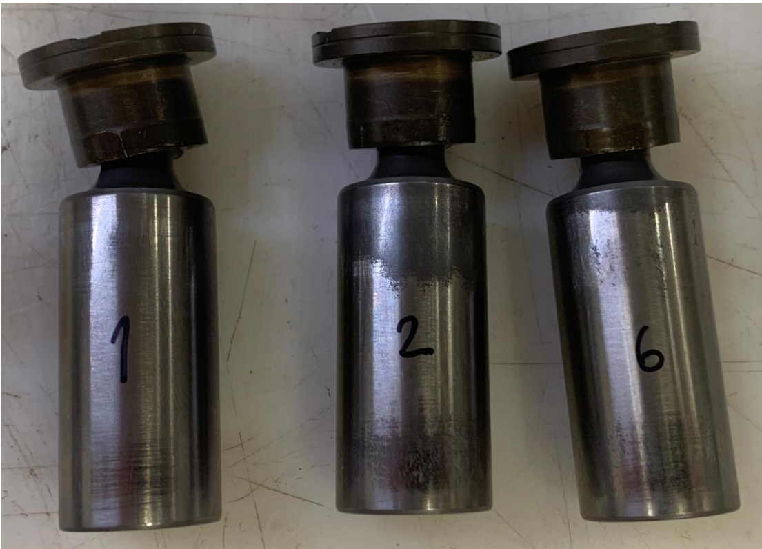
Kuva 8. Kohta A. Mäntien 2 ja 6 liukupinnoissa havaittu kuluma
