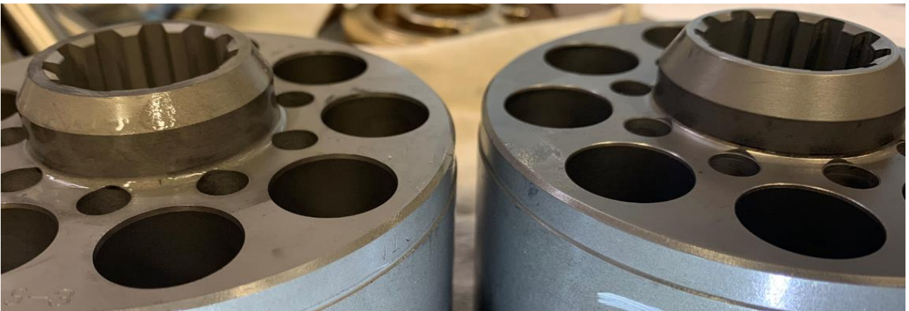
Kuva 15. Kohta B. Sylintereiden viisteet sekä akselikaran koneistuksen mitoitukset eroavat. Tutkittavassa sylinterissä ei esiinnyt jyrstyä tunnistetta "S-3"(Kawasaki vas, tutkittava oik)
