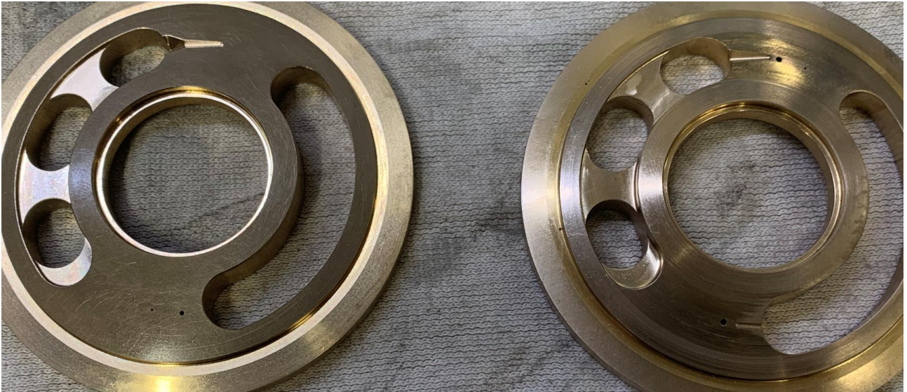
Kuva 22. Kohta B. Venttiililevyjen poraukset ja koneistukset eroavat (Flutek vas, tutkittava oik)
