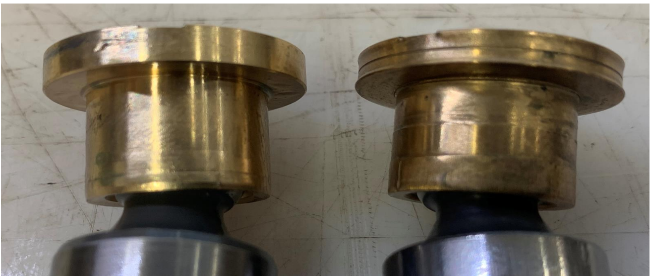
Kuva 13. Kohta B. Kenkien koneistus sekä kiinnityksen puristustapa mäntään eroavat. (Kawasaki vas, tutkittava oik)
