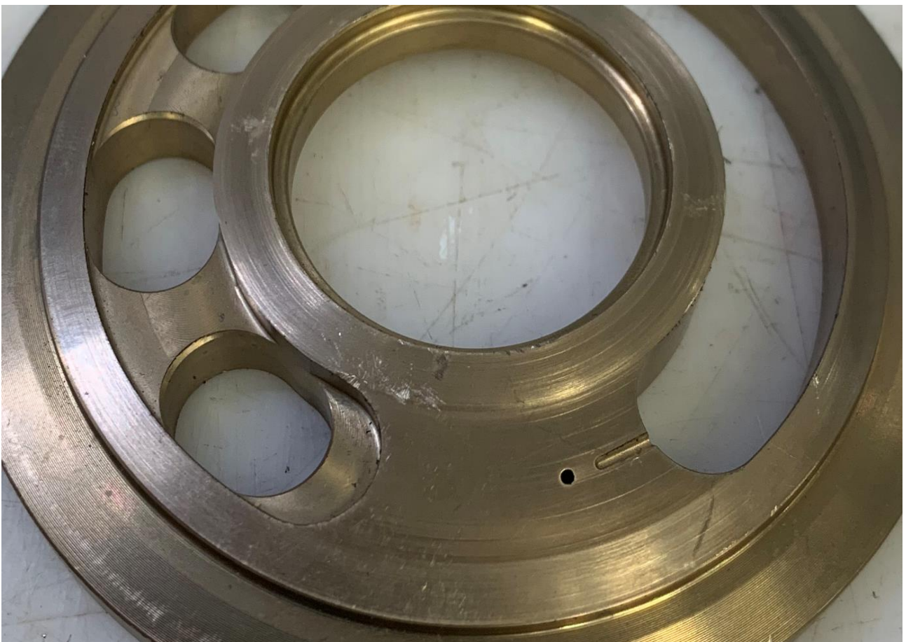
Kuva 10. Kohta A. Venttiililevyn liukupinnassa havaittu kuluma. Naarmut ja kolhut eivät liity toimeksiantoon.
