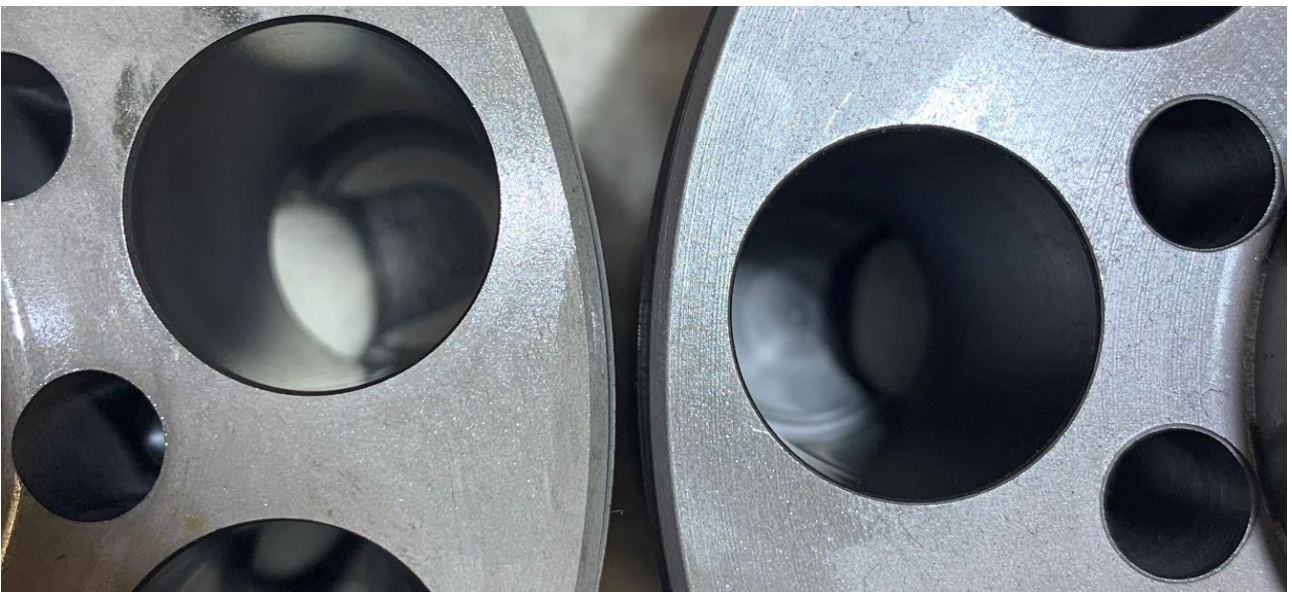
Kuva 16. Kohta B. Sylintereiden pohjien valu ja koneistukset eroavat. (Kawasaki vas, tutkittava oik)
