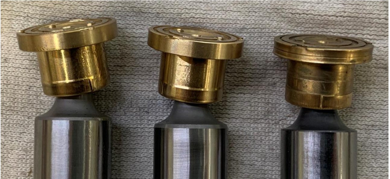
Kuva 19. Kohta B. Kenkien koneistus sekä kiinnityksen puristustapa mäntään eroavat. (Flutek vas ja keskellä, tutkittava oik)
